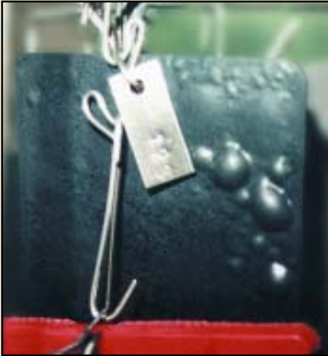
Abb. 5: Blasenbildung bei HNBR/T in Atmosphäre 2 nach 6 Wochen bei 80 °C u. 100 bar
